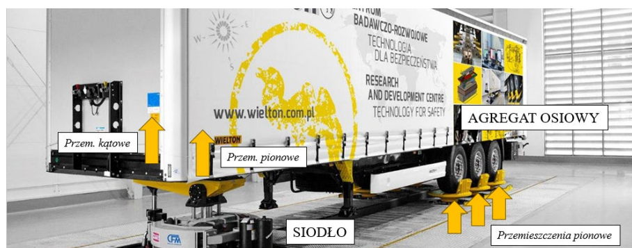
Rys. 11. Stanowisko badawcze MTS Road Simulator. Schemat przemieszczeń liniowych i kątowych przyjętych w analizie MES
