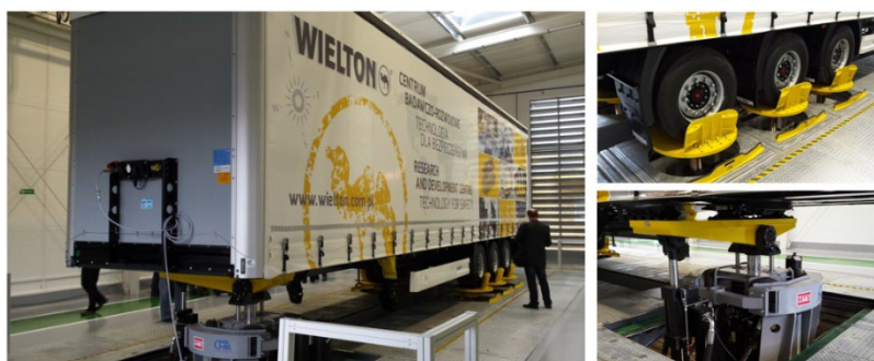
Rys. 15. Stanowisko MTS Road Simulator w Centrum Badawczo Rozwojowym w Wieluniu
