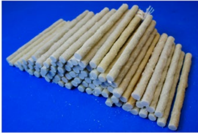
Rys. 10. Fragmenty wycięte z laminatu LPS [22]
