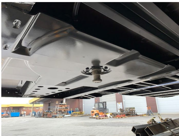
Rys. 5. Przykładowy formowany element – płyta podsiodłowa naczepy w ramie naczepy
