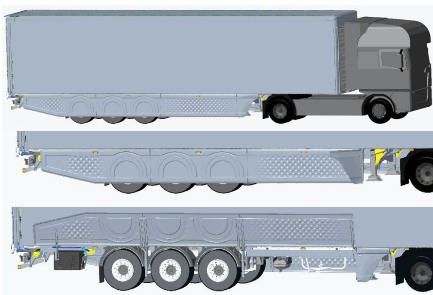
Rys. 5. Model naczepy wraz z pakietem aerodynamicznym w pozycji do jazdy, z uchylonym w bok przednim elementem oraz uchylonymi do góry pozostałymi bocznymi panelami
